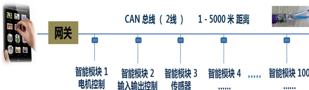
模块化分布式控制系统中的各个子系统相互独立且功能相同，因此它是严格意义上的分布式控制系统。与传统的控制系统相比，模块化分布式控制系统的突出特点是：模块化、可替代性、实时性、可扩展性、低成本。
